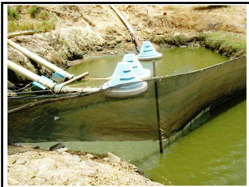
*Figura 44 – Ponto de captação de água com bombas.*
